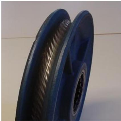
图 8-a 滑轮压痕示例
